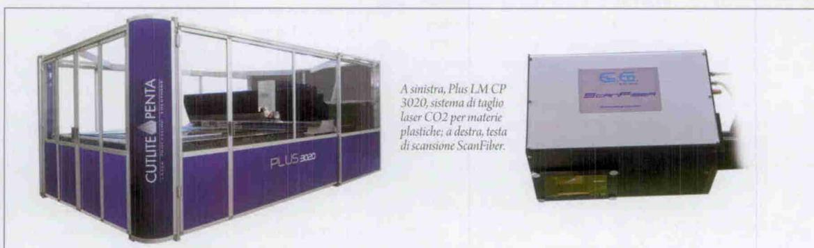
A sinistra, Plus LM CP 3020, sistema di taglio laser CO<sub>2</sub> per materie plastiche; a destra, testa di scansione ScanFiber.
